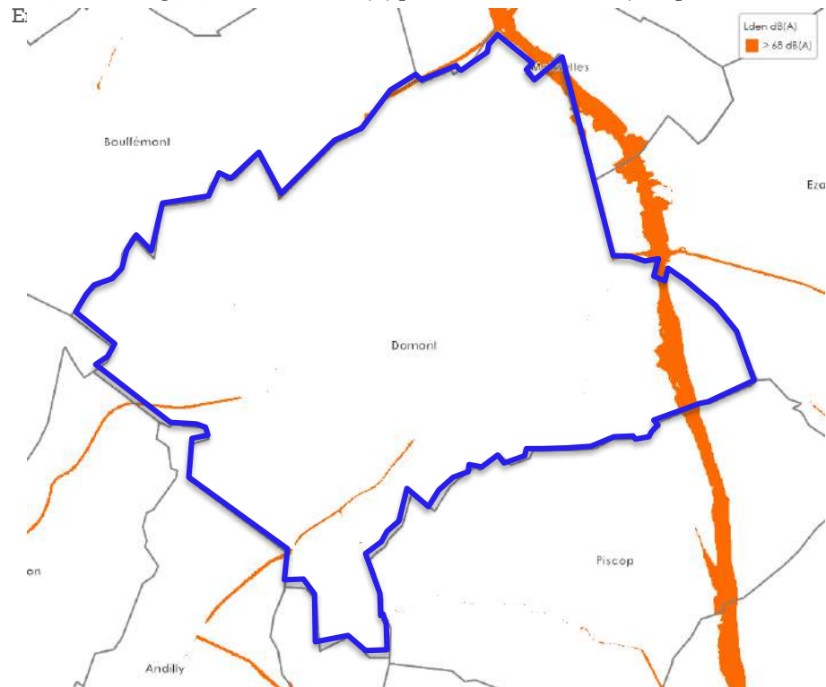
Carte de bruit stratégique sur la commune de Domont – zones de dépassement de la valeur limite réglementaire de 68 dB(A) pour l'indicateur Lden. (Bruitparif, IDE
